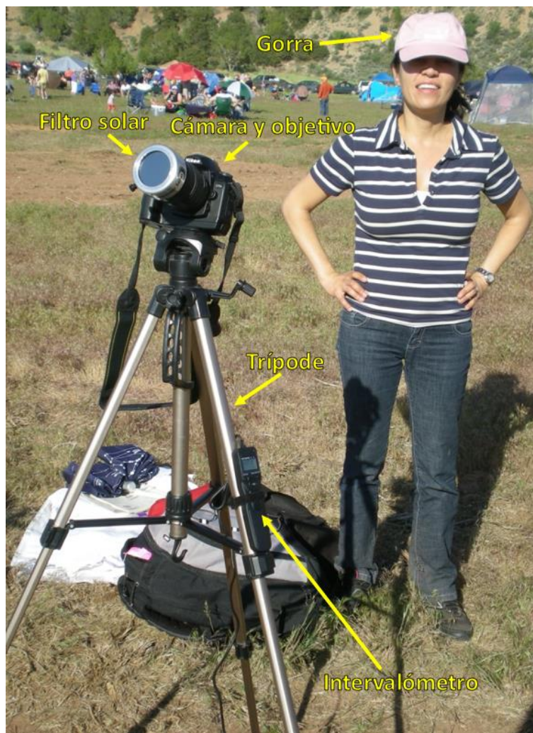
Figura 3. Instalación para fotografiar el eclipse con cámara (adaptado de https://eclipse.mx/eclipse-equipment.html )
