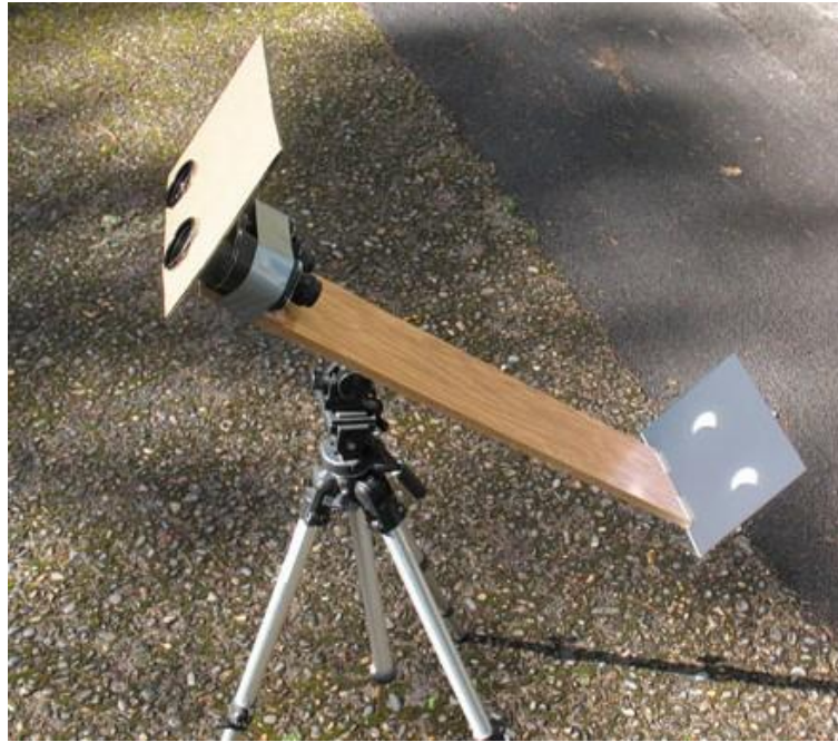
Figura 6. Proyección a través de binoculares ( https://skyandtelescope.org/2024-total-solar-eclipse/low-tech-eclipse-viewing/ )
