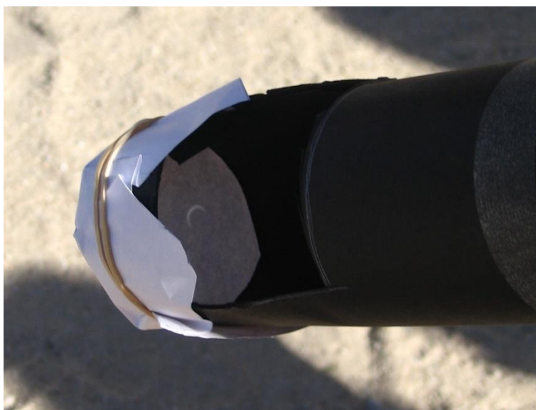
Figura 5. Imagen del Sol parcialmente eclipsado en una cámara oscura (Rafael Navarro)
